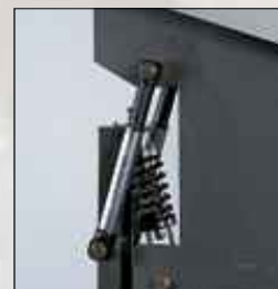
Le système exclusif d'auto équilibrage suspendu Girbau absorbe jusqu'à 95 % des vibrations, permettant ainsi aux laveuses d'être installées sans scellement et réduisant les coûts d'installation.
